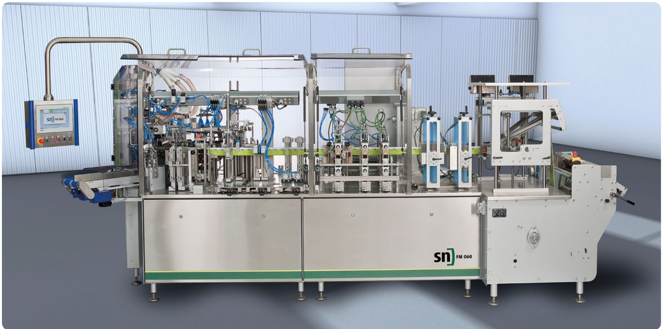
Auf der Fachpack ist auch eine FFS-Maschine für Doppelbeutel, die FM 060, zu sehen. Nach der Messe geht diese Anlage an einen multinationalen Lebensmittelhersteller. Beim Kunden leistet die FM 060 dann 100 Takte und dosiert zwei unterschiedliche Produkte in einen Beutel. (Fotos: SN Maschinenbau)
